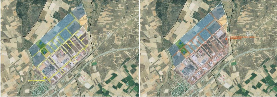
Ilustración 46. Esquema de las redes de electricidad y gas propuestas por el Plan Regional
